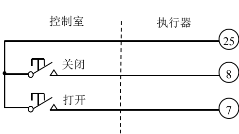
图 4-1 点动式打开/关闭控制，执行器可以停在中途任意位置
